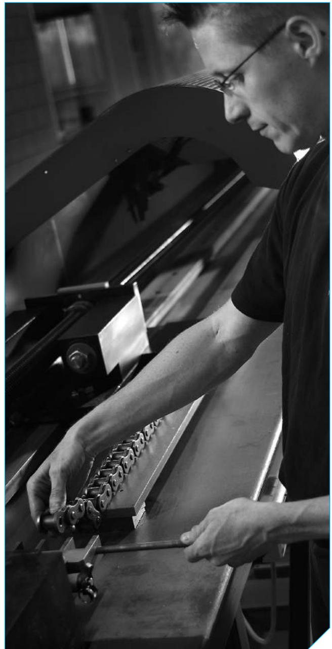
Abb. 29 Paarweises vorrecken für Parallellauf
